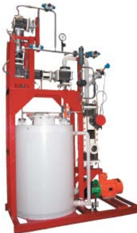
Вакуумный агрегат 3-х ступенчатый; 600м³/час; 1мбар
