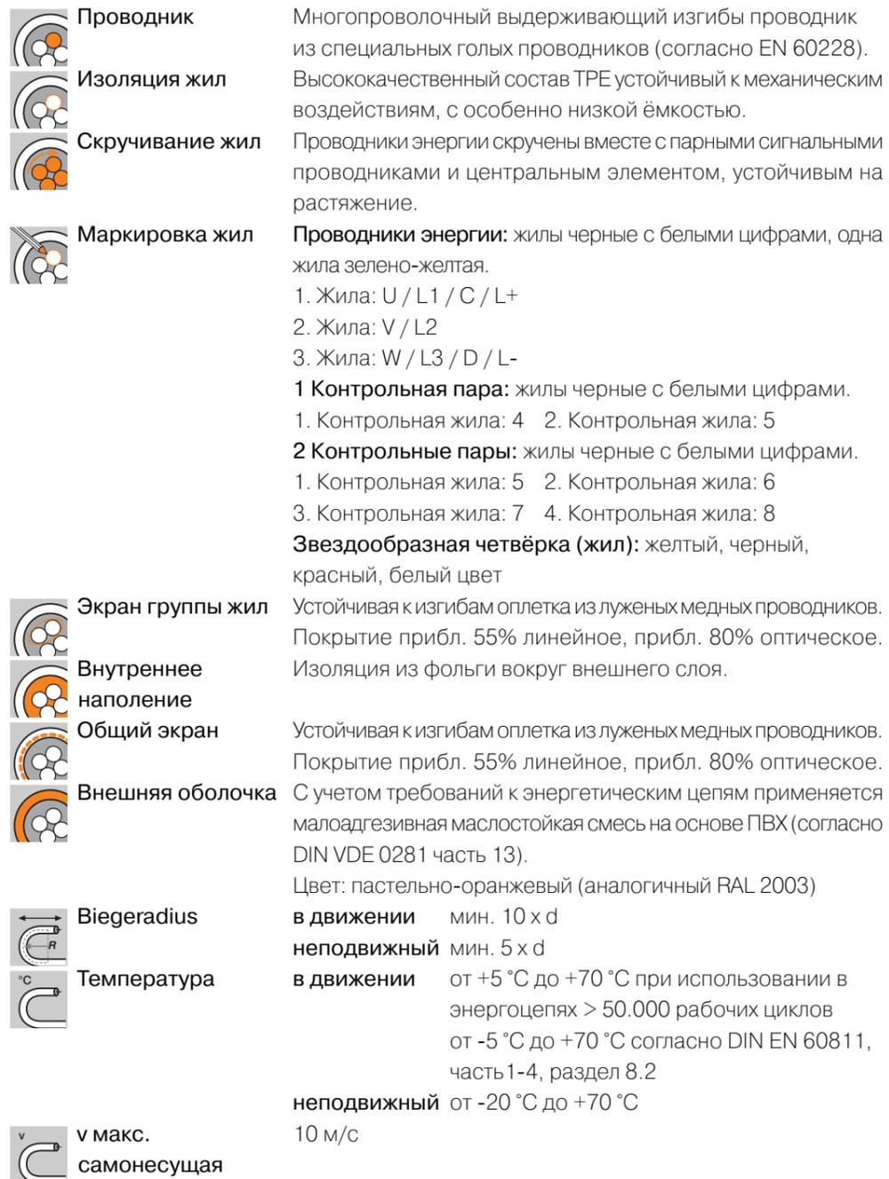
**Проводник** Многопроволочный выдерживающий изгибы проводник из специальных голых проводников (согласно EN 60228).
