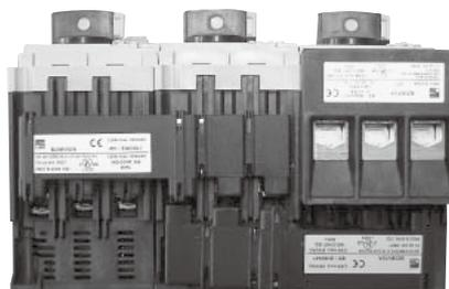
Примечание: Когда необходимо подключить три или более сборных шин, следует поочередно вставлять последующие шины в верхние и нижние части клеммных колодок. (Автоматы защиты электродвигателя могут быть установлены вплотную друг к другу).
