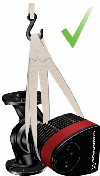
Рис. 9 Правильный способ строповки насоса
