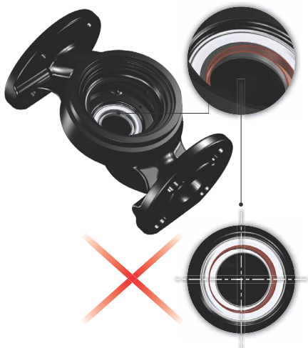
Рис. 15 Неправильно выровненная система уплотнений
